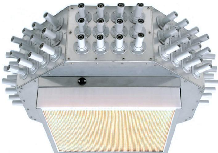
Das Hygrex-Deckenluftverteilersystem DLV 3000/8 beinhaltet einen drehzahlgeregeltem Ventilator, welcher auf der Unterseite Raumluft durch einen PP-Filter ansaugt und über das Hygrex-5-Kanal-Punkt-Düsen System wieder unter der Decke ausbläst.
